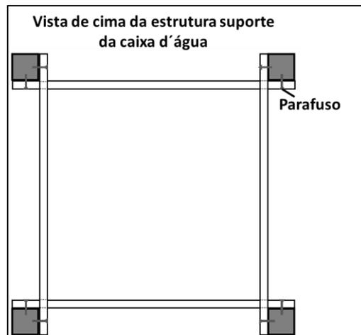
Ainda em relação às estruturas que dão suporte as caixas d'água, a indicação é que os pilares sejam enterrados a 1 metro de profundidade no solo, o que garante um bom atrito e aderência lateral tanto para a estrutura da caixa de 1.000 litros, quanto para a estrutura da caixa de 5.000 litros.
