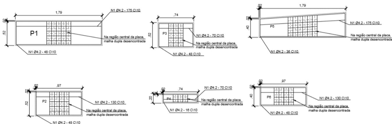
Essa malha dupla é fundamental no processo construtivo das placas, pois reforça a estrutura e viabiliza um transporte seguro da mesma, principalmente quando o transporte de material se dá por longas distâncias e em condições precárias, que é o caso dos domicílios atendidos pelas tecnologias sociais na Amazônia.
