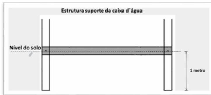
Vale destacar que a estrutura deve ser parafusada nos pilares a fim de garantir a sustentação da força exercida pelo peso da caixa d'água, conforme ilustrado na figura 9.
