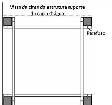
Ainda em relação às estruturas quedão suporte da caixa d'água, a indicação é que os pilares sejam enterrados a 1 metro de profundidade no solo, o que garante bom atrito e aderência lateral tanto para a estrutura da caixa de 1.000 litros, quanto para a estrutura da caixa de 5.000 litros.
